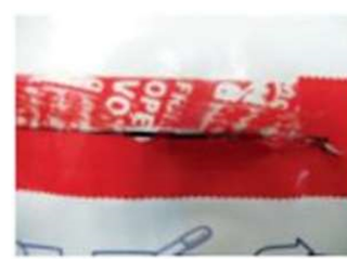
Разрушение сейф-ленты при ее отрывании, индикация факта вскрытия
