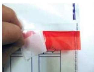
Снятие защитной ленты (лайнера)
